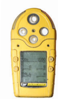
Gaswarngerät: Misst allenfalls auftretende gefährliche Gase, damit die Mitarbeiter gewarnt werden.
