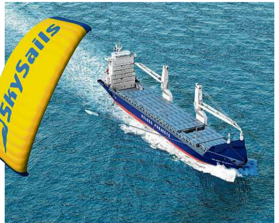
Ein großer Container-Frachter wird bei seiner Fahrt über das Meer von einem Segel mit der Aufschrift Sky Sails gezogen (Fotomontage). Als weltweit erste Reederei setzte die Bremer Beluga Shipping ab 2007 das Wind-Antriebssystem ein. BILD: DPA
