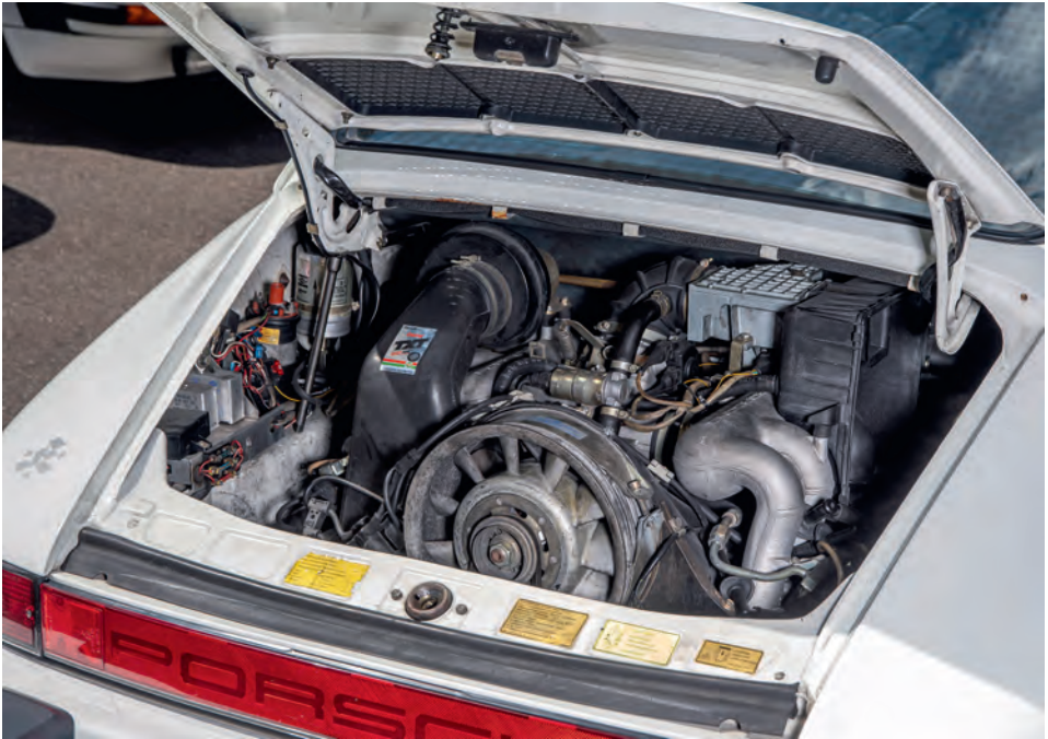
Der originale Motor in der G-Serie – optisch sehr ähnlich zum hubraumstärkeren 964er
