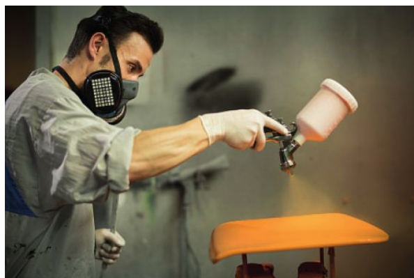
Ein Freischwinger entsteht: Das Stahlrohr wird in Form gebogen und geschliffen, Sitz und Rücken aus Holz werden lackiert. Fotos: Philipp Thonet
