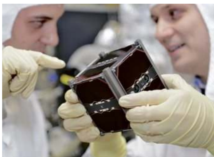
Nur ein Kilogramm schwer: UWE-3, der sich selbst reparierende Mini-Satellit aus Würzburg Foto: David Ebener/dpa
