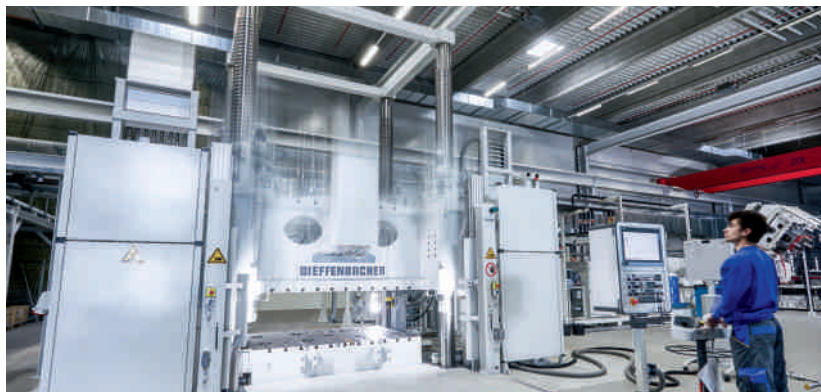
100 Tonnen-Pressen im Forschungszentrum der KDX Europe Composites R&D.
