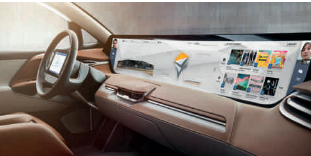
Das 48-Zoll Shared Experience Display ersetzt die herkömmliche Mittelkonsole und das Armaturenbrett.
