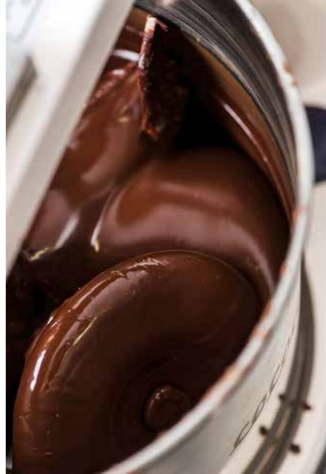
Laura Schälchli begutachtet den Rohstoff, die zerkleinerten Kerne der fermentierten und getrockneten Kakaobohnen. In der Conchiermaschine entsteht daraus nach Stunden die cremige Schokomasse.
