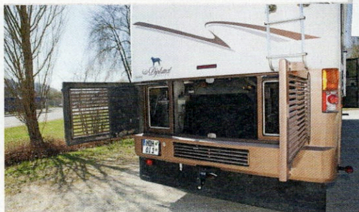
Hinter den Heckklappen sitzen der Kühler und ein riesiges Lüfterrad
