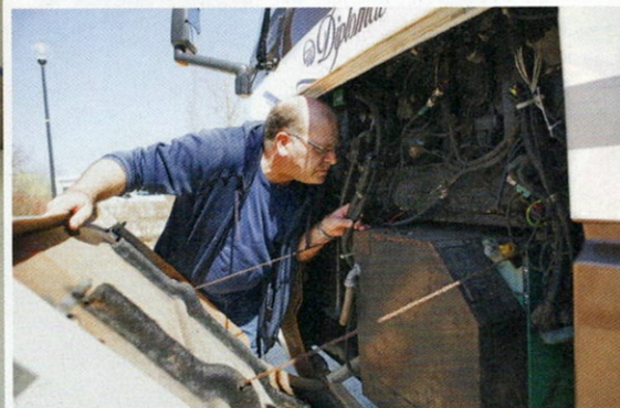
Olaf prüft den Dieselgenerator, der vorn unter dem Cockpit sitzt
