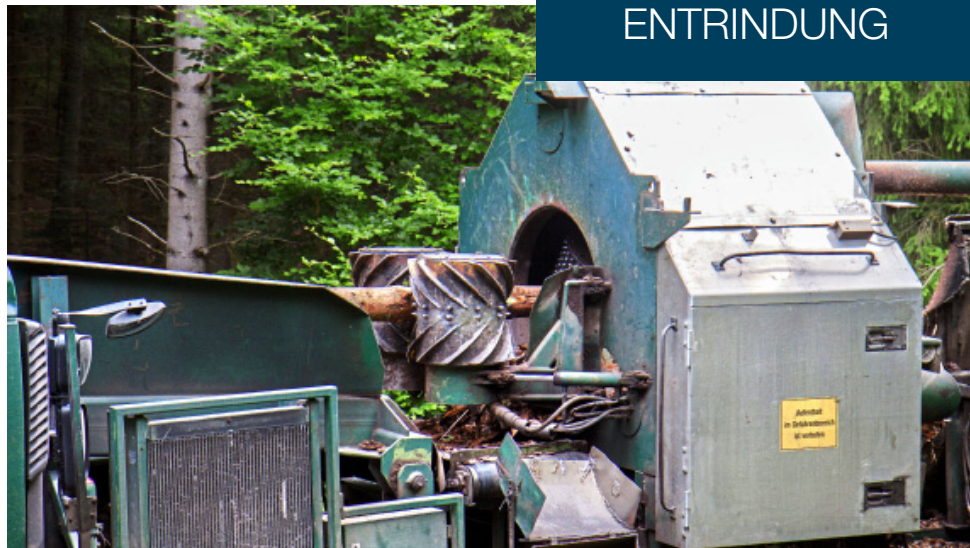
Blick von hinten auf den Entrindungsrotor
