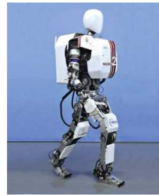
Wabian 2 war einer der ersten menschenähnlichen Laufroboter. Seit Ende des vergangenen Jahres hat er eine neue, flexible Hüfte. Mit der kann er zwar noch keinen Samba tanzen, aber zumindest ruckelt er weniger beim Gehen
