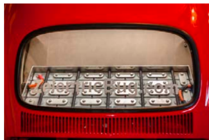
Hinter dem Rücksitz hat der e-Käfer eine Akkubox mit 25 Lithium-Ionen-Zellen.
