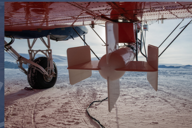
Vorgänger Die magnetische Schleppsonde ('Bird') in ihrer Halterung unter dem Rumpf. Im Flug wird sie abgelassen und erfasst die Dicke des überflogenen Meereises. Foto Esther Horvath // AWI
